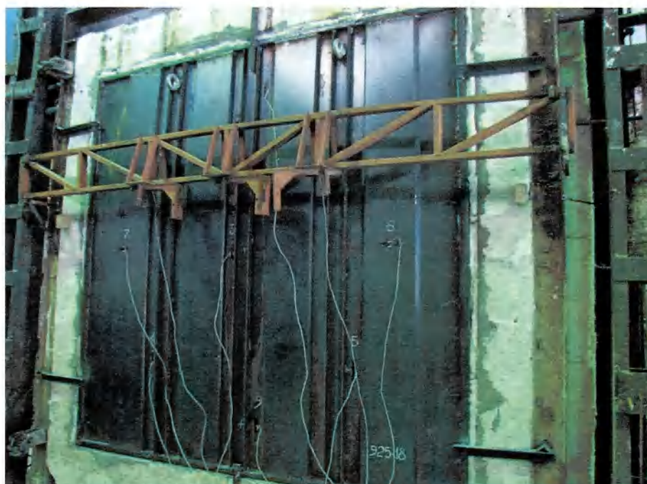
Foto 2 – Face não exposta ao fogo e instrumentação do corpo de prova.
