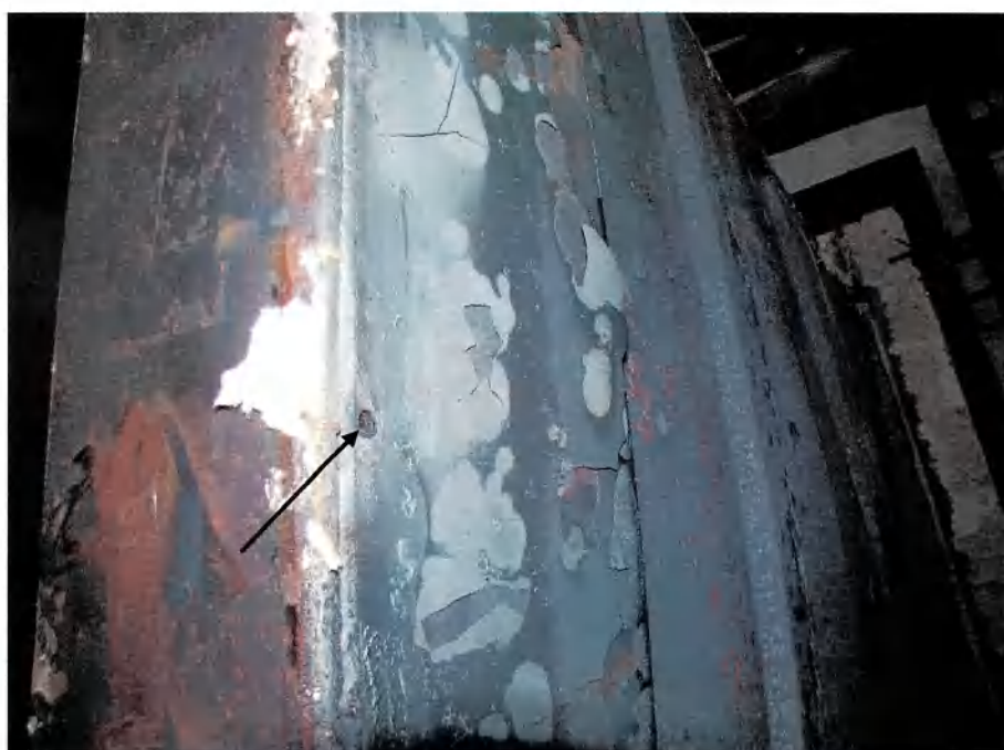
Foto 6 – Detalhe da face exposta ao fogo do corpo de prova. Vista do respiro realizado na lateral do corpo de prova para o alívio da pressão interna.
