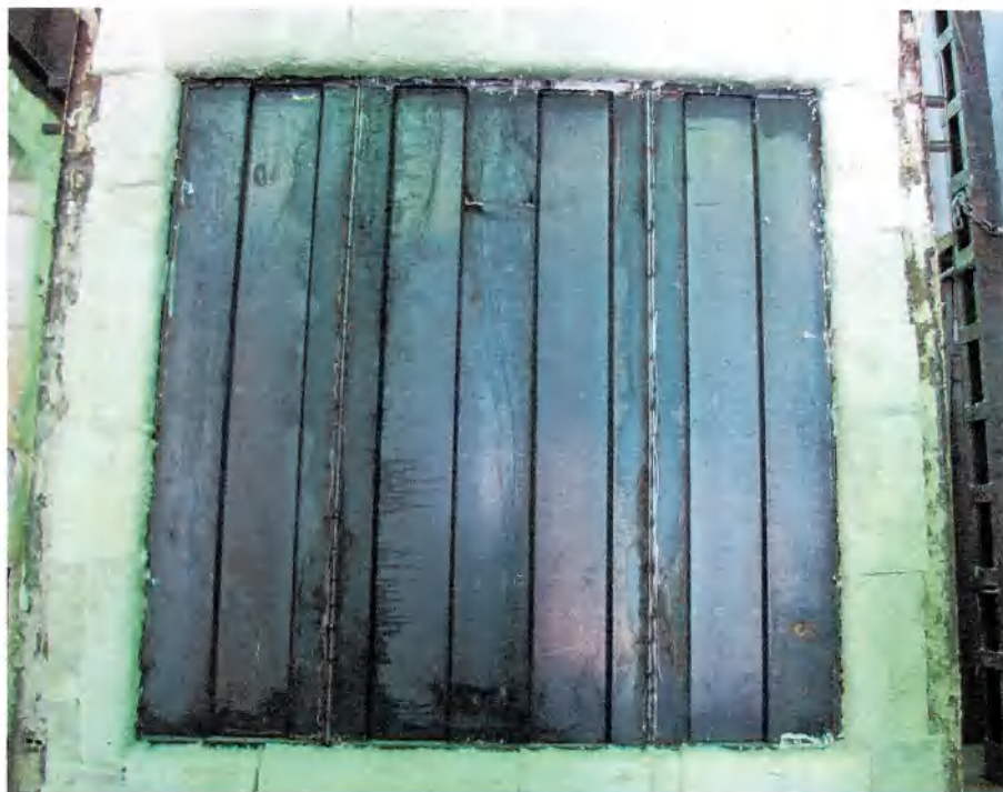
Foto 1 – Face exposta ao fogo do corpo de prova.
