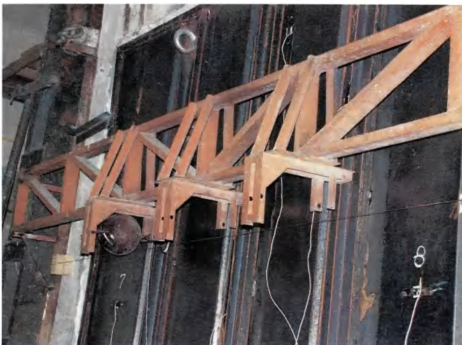
Foto 4 – Teste do choque mecânico durante a realização do ensaio de resistência ao fogo
