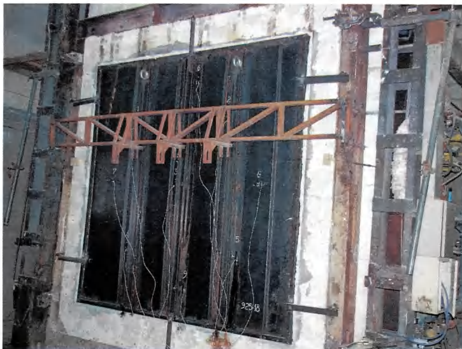
Foto 3 – Realização do ensaio de resistência ao fogo.
